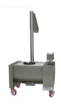
Il corpo macchina può essere montato su ruote piroettanti o su piedi regolabili secondo le esigenze del cliente. La coclea di scarico, di altezza variabile secondo le esigenze del cliente, consente un rapido svuotamento della vasca. A richiesta il miscelatore può essere dotato di celle di carico per pesare le quantità di prodotto lavorato e di sistemi di dosaggio automatico degli ingredienti.
