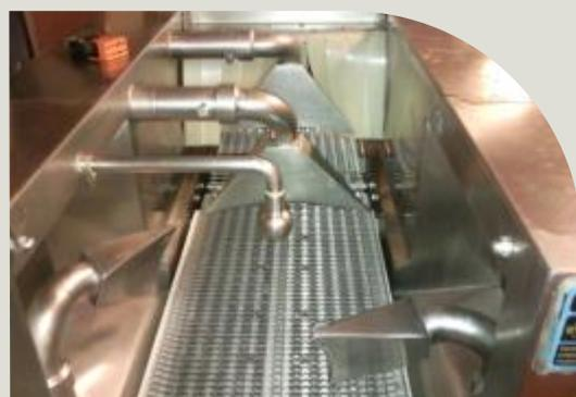
LA MACCHINA è DOTATA DI SERIE DI IMPIANTO DI LAVAGGIO CENTRALIZZATO PER UNA PIU' RAPIDA PULIZIA A FINE LAVORAZIONE
